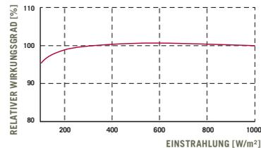
Typische Modulleistung unter niedrigen Einstrahlungsbedingungen im Vergleich zu STC-Bedingungen (25 °C, 1000 W/m<sup>2</sup>).
