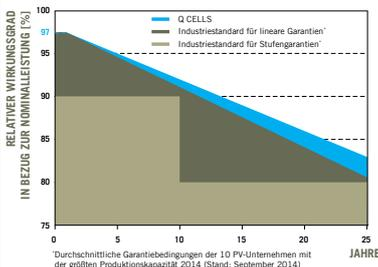
Mindestens 97% der Nennleistung innerhalb des ersten Jahres. Danach max. 0,6% Degradation pro Jahr. Mindestens 92% der Nennleistung nach 10 Jahren. Mindestens 83% der Nennleistung nach 25 Jahren.
